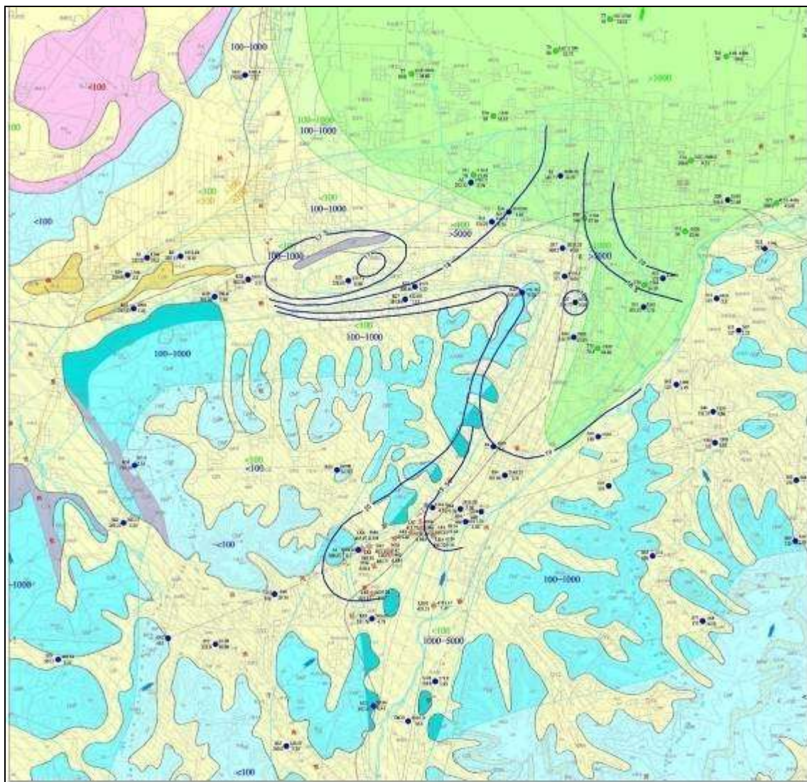
图 5-13 (a) 大武富水区等水位线图（枯水期）
